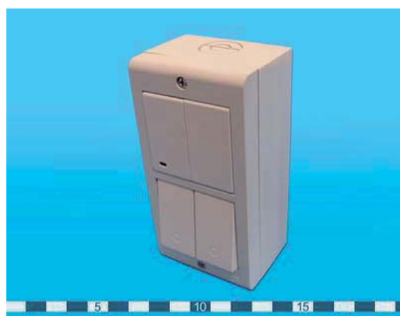
AVE 01 de superficie pared sin llave
